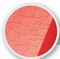
Tecnología **Nanogrip** HSM: la composición de materiales especialmente desarrollada por la empresa y la estructura de la superficie de los rodillos de transporte y alimentación garantizan una destrucción y alimentación fiable de todo tipo de materiales, incluso si están sucios. El rendimiento no se ve afectado por un uso frecuente.
